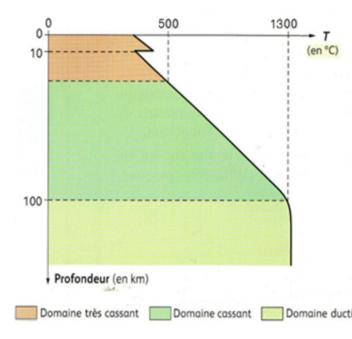
Lorsque les roches sont soumises à des contraintes mécaniques, elles peuvent résister à celles-ci sans se déformer tant que les contraintes sont inférieures à leurs seuils de résistance. Au-delà, elles se déforment.
